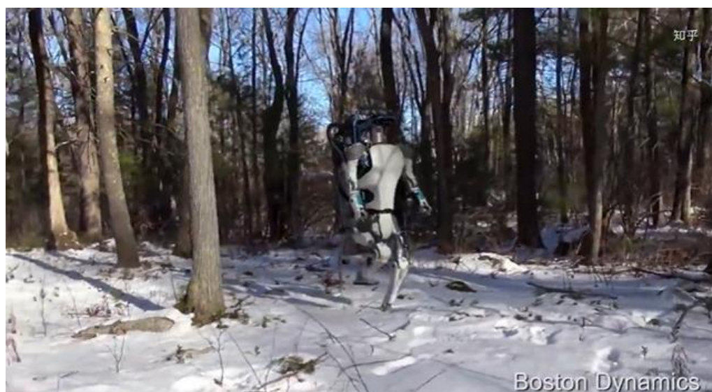
图 2: Atlas 在不平坦的雪地上行走时需要实时且精确的力反馈
