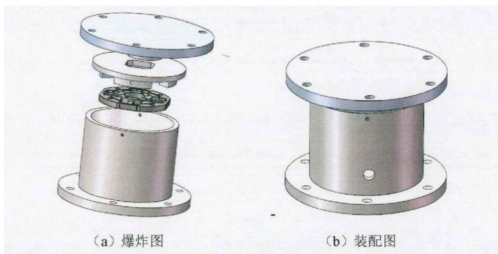
图 6：力矩传感器的基本结构
