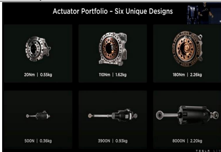
图 43：特斯拉 Optimus 关节执行器主要分为 2 大类 6 种：3 种旋转+3 种线性
