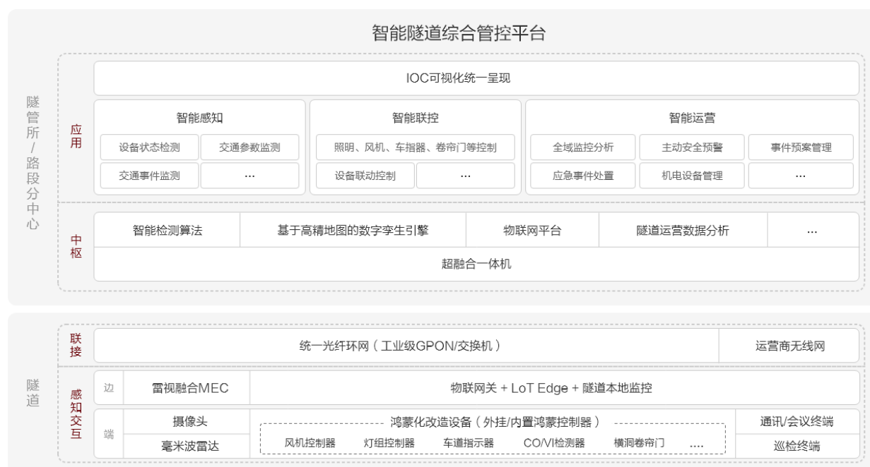
图 36：隧道场景下的鸿蒙化设备及智能隧道综合管控平台
