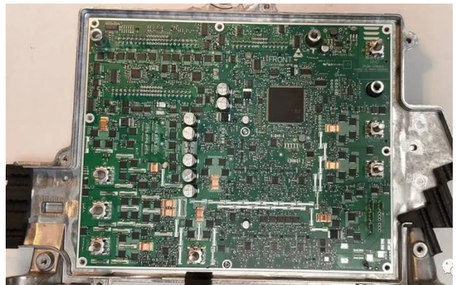
图 57: 前车身域控制器 PCB 板
