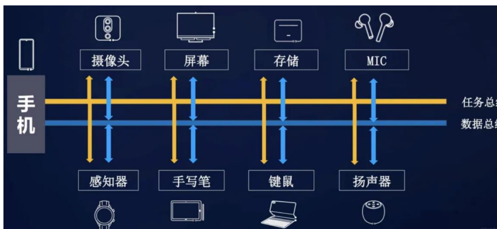
图 9：分布式软总线将不同终端整合于一个统一的通信框架之下
